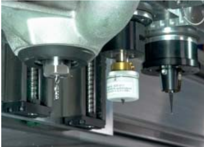
Bild 3 – Fräs- und Schneidwerkzeuge einzeln ansteuerbar
