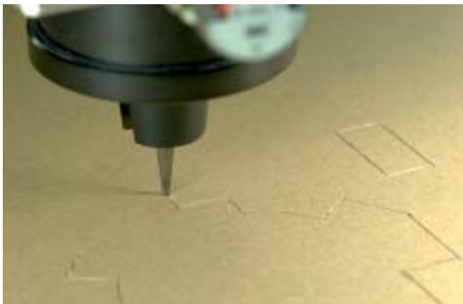
Bild 4 – Oszillierendes Schneidmesser für exakte Ausschnitte
